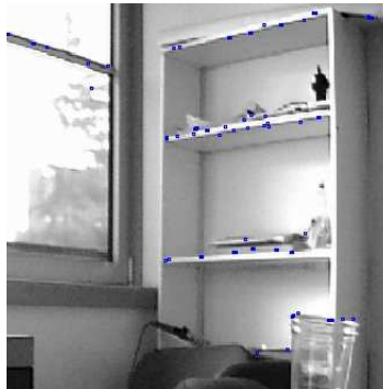
FIG. 5 – Exemple d’application du filtre de Harris, les points caractéristiques étant indiqués en bleu.
